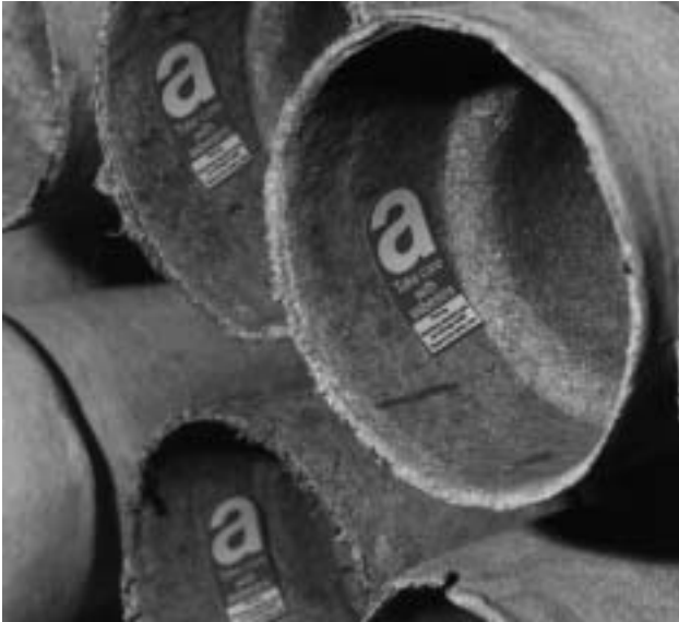
11e Asbestos cement pipes.
